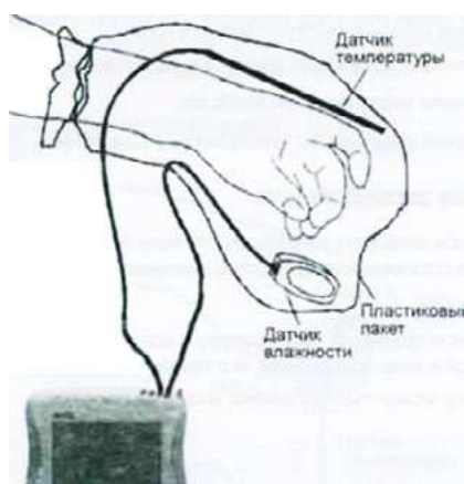
Рис. 17. Схема экспериментальной установки терморегуляции кожи
